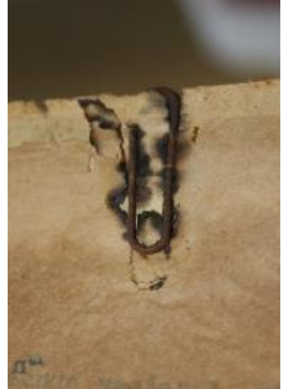
Deterioro originado por un clip
